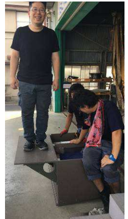
受け板の耐荷重実験
