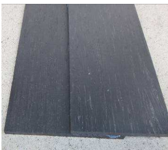
板の重ね貼り (板圧着により 液は拡がる)
