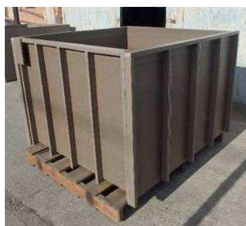
プランター側壁に角材補強
