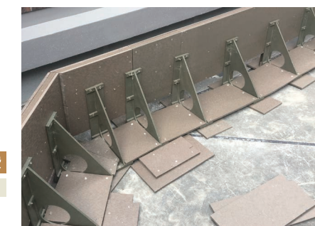
曲面スタンドCPタイプ R2,000 L1,200mm → CAD図に従い製作
