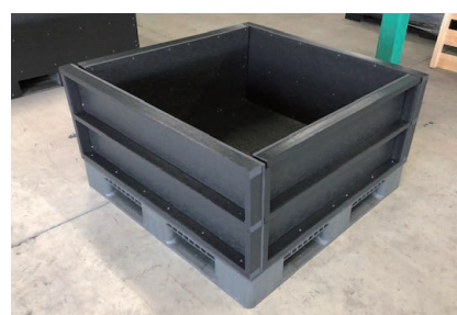
リプラfボードの上の側板に角材を横三段設置
