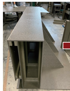
リプラ板でLEDベルトを付けられるベンチを製作
