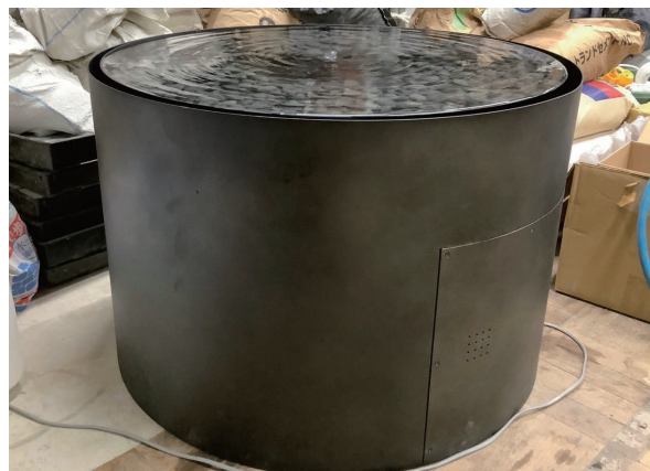
循環ポンプを内蔵したステンレス製水盤
