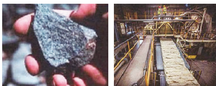
天然石を高温で溶融し遠心力で吹き飛ばして繊維状に加工してGRを生産…フェノール等不使用
