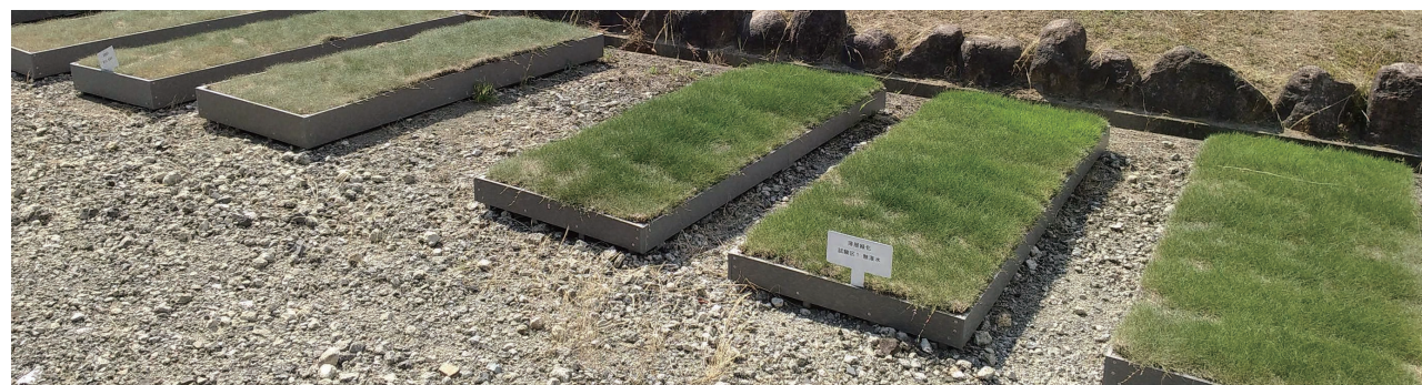
公式無灌水実験 高麗芝2022年4月22日植付け 6月30日時点 左 従来方式土100mm+排貯水マット25mm 右 土20mm+GR40mm+排水DM20mm
