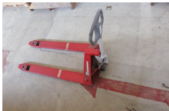
ハンドリフトは1t用・2t用等各種あり、ハンドルを上下させるだけでパレットが持ち上がり、そのまま手作業で簡単に植栽入りプランターを移動出来る
