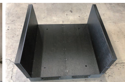
リプラfボードの上に側板を設置
