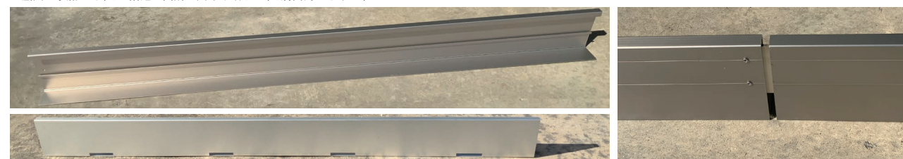
アルミスタンド H100xL2,000mm 折り返し補強 & ジョイント差し込み受け補強品 穴あけ加工は後工程で処理 場所&数量自在 直線ジョイント部の目地空け接続 片側のみビス止め
