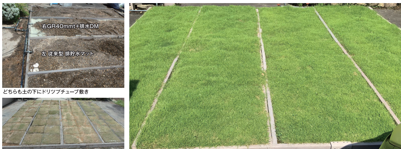
2021年8月27日 わかば植栽 左 従来型 排水DM 右GR型は均一に生育・伸長している
