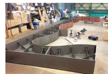
リプラf曲面プランターにデッキ板張り 分解して出荷
