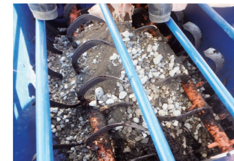
混合機械により根の誘導路盤材製造
