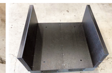
リフライフットボードの上に側板を設置
