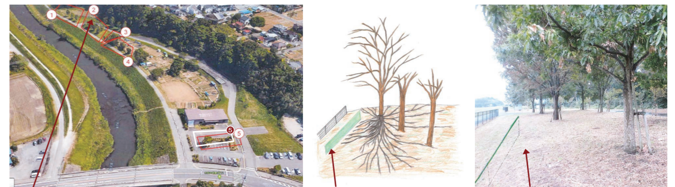
②の区域にくるくるストップシートを埋設...他と比較観察 樹木の根が遊歩道に出ないようにくるくるストップシートを地下に埋設 1m巾
