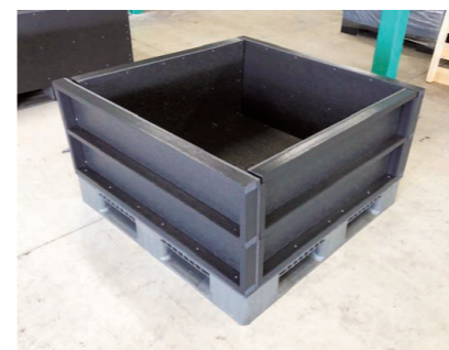
リフライフットボードの上の側板に角材を横三段設置
