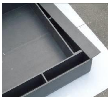
上板を枕木 コの字 (上板なし) と約 12cm ずらして、載せる
